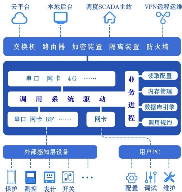
图 1-3 通讯管理机工作原理图
