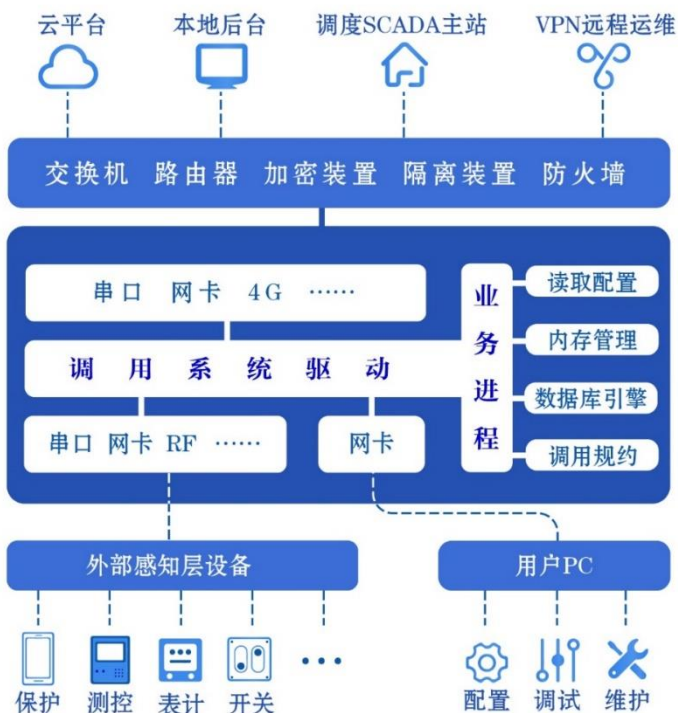
图 1-3 通讯管理机工作原理图
