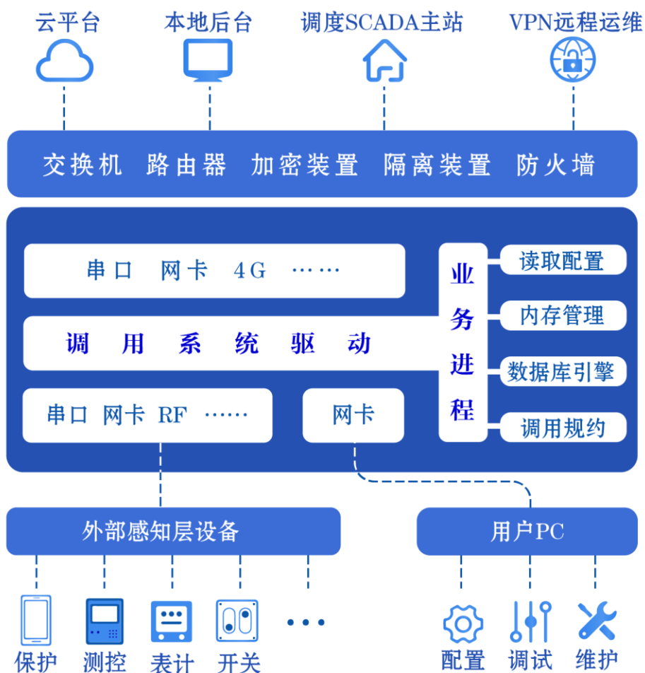
图 2-3 通讯管理机工作原理图
