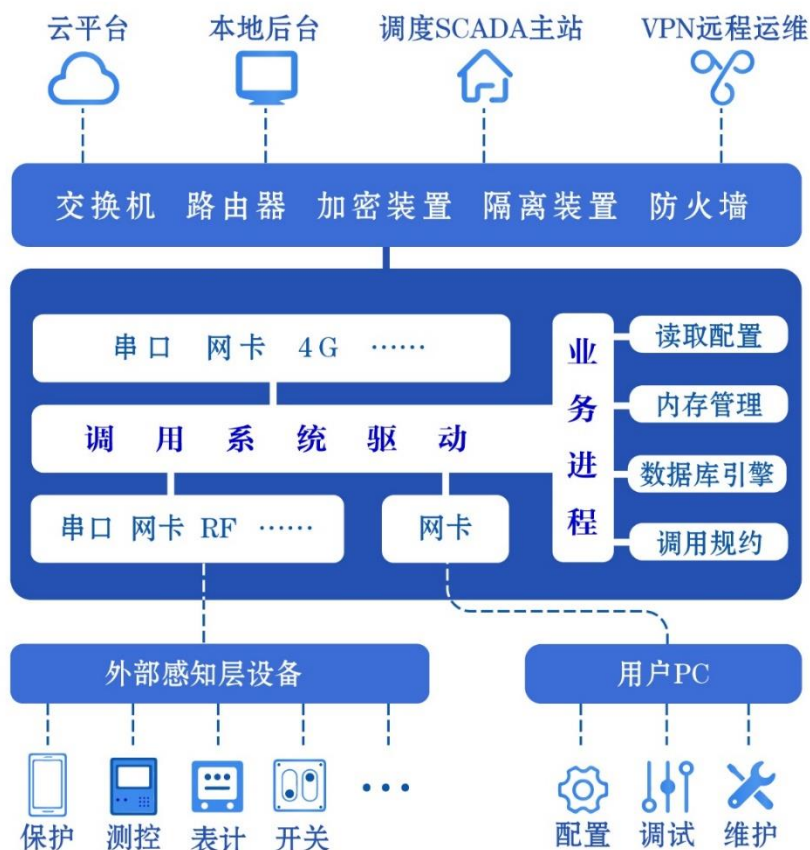
图 2-2 通讯管理机工作原理图
